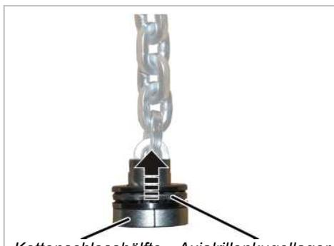
→ Dreiteiliges Axialrillenkugellager nach oben schieben.
